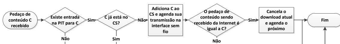
Figura 2. Fluxograma do processo de recebimento de uma parte de conteúdo pelo AP.
