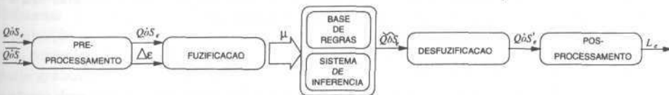
Figura 8: Diagrama de blocos do controlador global nebuloso
