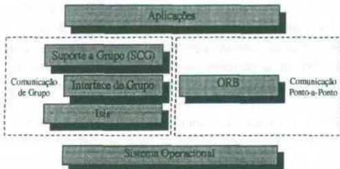
Figura 4.1 Estrutura da implementação da abordagem de serviço.
