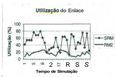
Figura 10 - Utilização do enlace sem fio no SRM e no RM2
