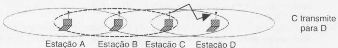
Figura 21. Problema do Terminal Exposto
