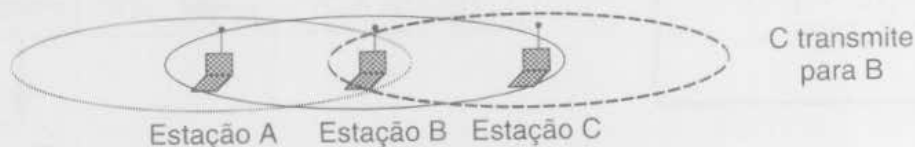
Figura 7. Problema do Terminal Escondido
