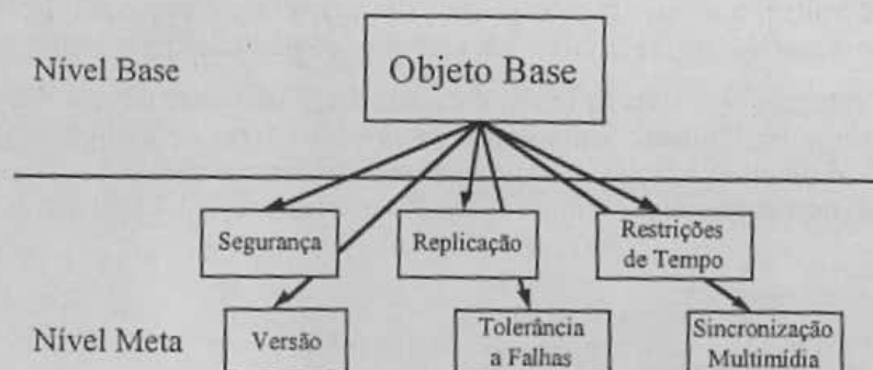
Figura 3.4 - Reflexão utilizada para adicionar características não-funcionais
