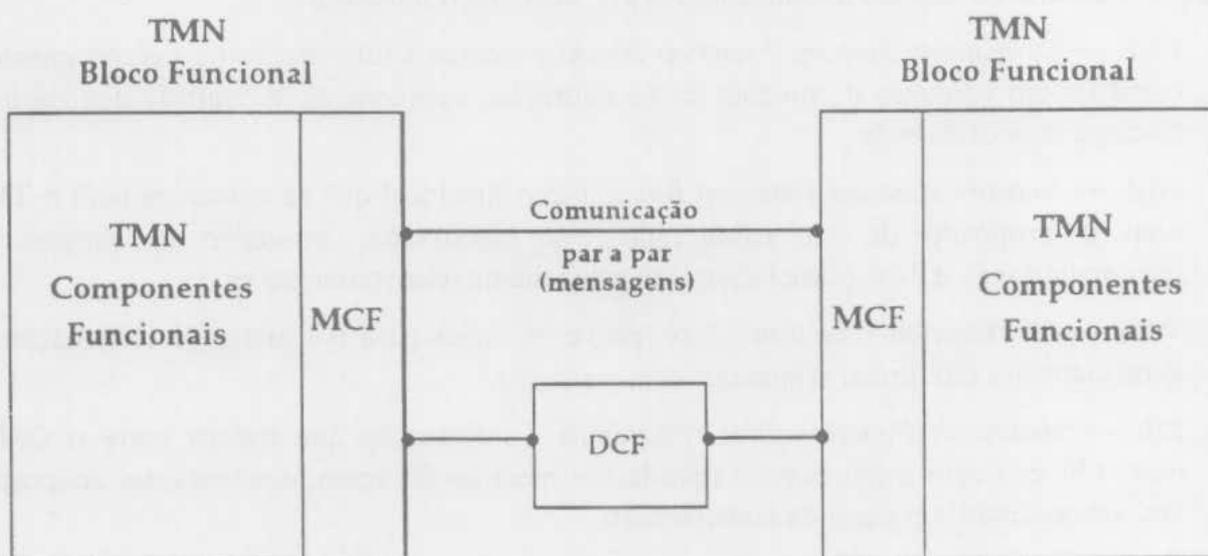
Figura 2: Relação da MCF e da DCF com os blocos funcionais
