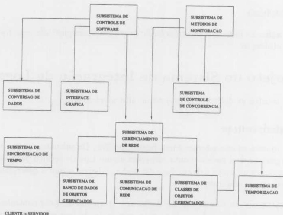
Figura 7: Subsistemas do Sistema de Integração de Logs
