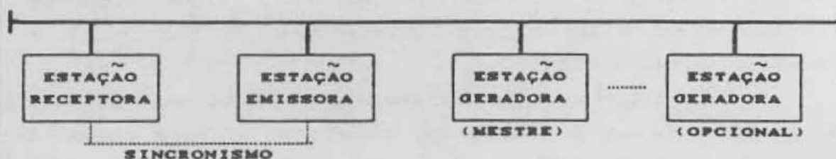
FIG. 3.2: CONFIGURAÇÃO DOS TESTES DE ATRASO
