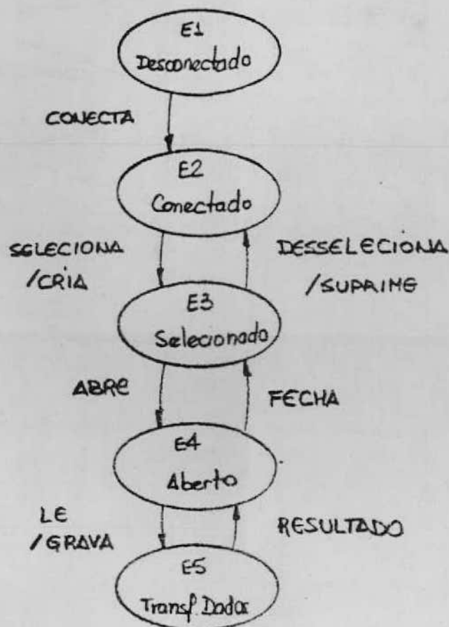
Figura 3.4 - Diagrama de estados referente a operação normal do módulo de interface com o usuário
